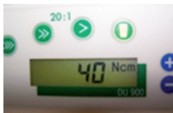
FIGURA: Con torquímetro electrónico o manual, es fundamental lograr una fijación inicial mayor a 30 Newtons.
