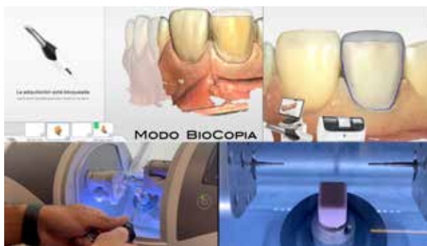
FIG. 4: Escaneo digital en CEREC Primescan, fresado en MCXL utilizando un bloque IPS e.max CAD MT BL3
